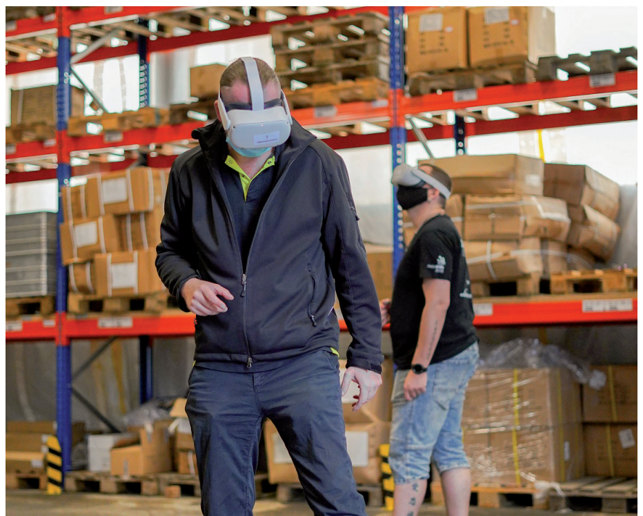
Mittels VR-Brille kann eine vollumfängliche Regalinspektion erfolgen, wobei ein virtuelles Lager 1:1 abgebildet wird.
