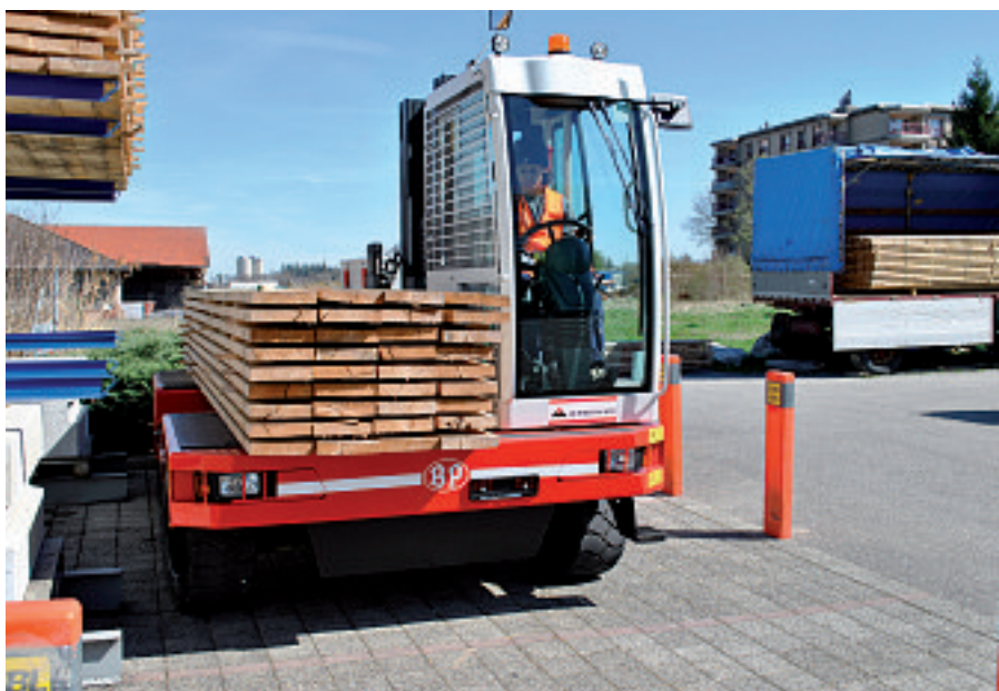
Le chargement latéral est particulièrement adapté à la manutention d'objets longs (tuyaux, poutrelles, etc.).
