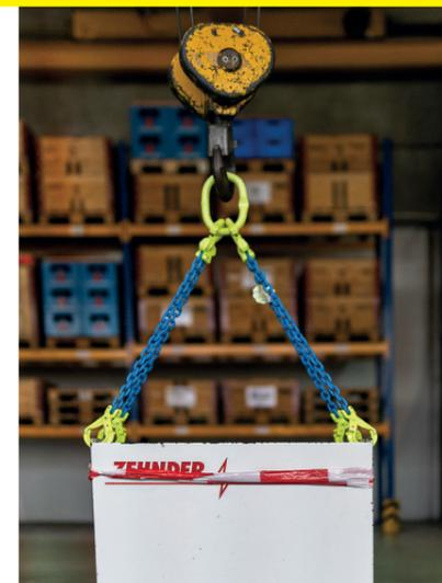
Korrektes Anschlagen von Lasten.
